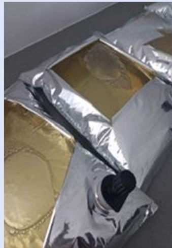
Малюнок 1: Вільний простір значно різниться у різних BiB. Це призводить до високої мінливості якості та терміну придатності вина в межах однієї розливої партії..
