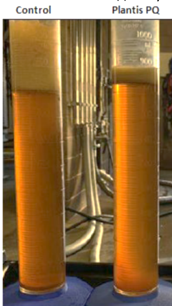
Рисунок 4. Влияние Plantis PQ (10 г /л) на образование флоккул в сравнении с контролем без добавления оклеивающих веществ
