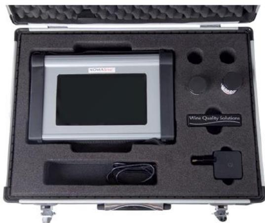
НомаСенс Полискан С200 - первый анализатор, применяемый для измерения содержания полифенолов в сусле или вине на разных стадиях виноделия в режиме реального времени. Метод простой, прямой и быстрый. Образец в виде капли без какой-либо подготовки наносят на одноразовые электроды. Результаты отображаются на сенсорный экран анализатора через несколько секунд в форме индексов-EasyOx и PhenOx, указывающие соответственно уровни легко окисляемого и общего полифенолов.
