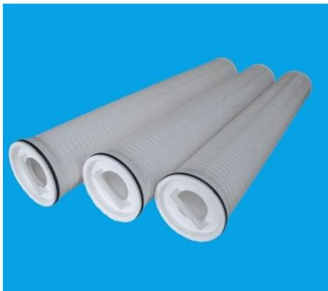
Высокоэффективные фильтроэлементы глубинного типа изготовлены из полипропиленового микроволокна по технологии, позволяющей создавать несколько зон фильтрации внутри одного элемента. Конструкция с несколькими зонами образует структуру с постепенно уменьшающимся размером пор, которая эффективно захватывает более крупные частицы во внешних слоях фильтроэлемента, а затем тщательно и последовательно удаляет более мелкие частицы во внутренних слоях.
