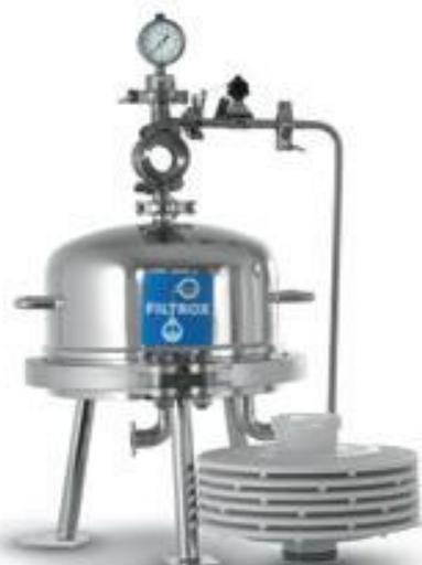
Модули глубинной фильтрации FILTRODISC™ работают в герметично закрытом корпусе DISCSTAR™. Внутренний жесткий сердечник модуля соединен с коллектором фильтрата корпуса. Пространство между модулем и корпусом заполнено нефильтрованным продуктом. При работе движущей силой потока жидкости является дифференциальное давление между входом и выходом, что приводит к ее протеканию через
