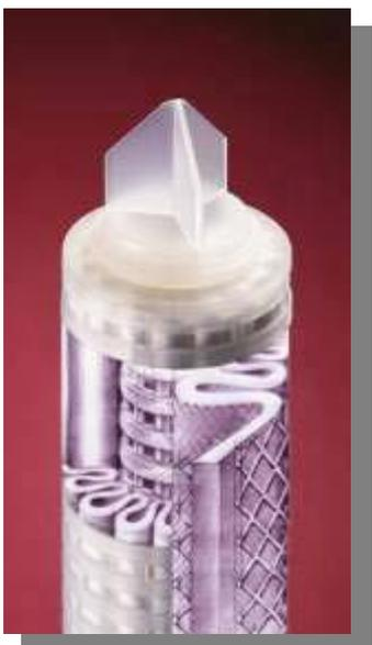
Фильтроэлементы могут быть также комбинированными. Например, **CANDEFILT HMVS**. Он имеет двухслойный фильтрующий материал. Первый слой – глубинник – стекловолокно с дзета-потенциалом, второй слой – полиэфирсульфонная мембрана, рейтингом 0,45-0,65-0,8-1,2 мкм. Это очень эффективный инструмент полирующей фильтрации.
