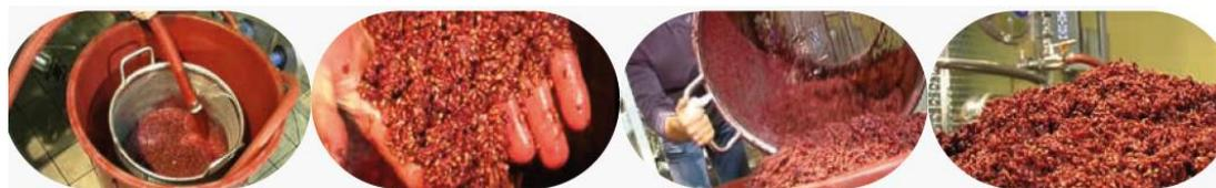
В первые дни брожения, Soft System® позволяет с помощью специального зубчатого скребка, легко и эффективно удалить осевшую на дно виноградную мезгу.
