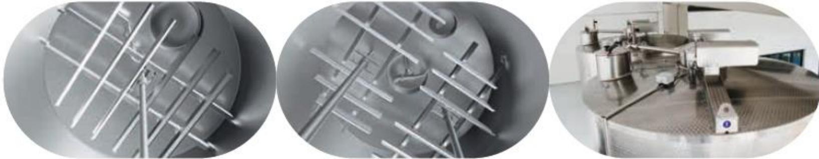
Система перемешивания позволяет использовать ее многофункционально и имеет следующие преимущества: оптимизирует растворение красящих пигментов на протяжении всего процесса мацерации, функционируя с минимальным уровнем шума. Дополнительное преимущество – компактность системы, позволяет оптимизировать пространство винных погребов.
