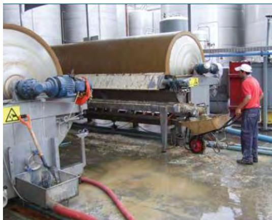
Барабанный ротационно-вакуумный фильтр, традиционный метод отжима вина из осадка.
