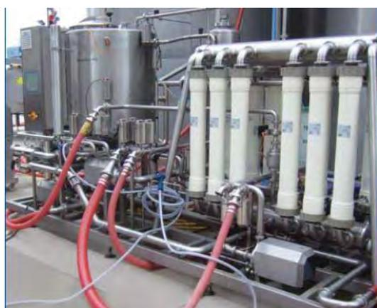
12-модульная система Oenoflow HS-A, новая технология Pall для отжима вина из осадка.
