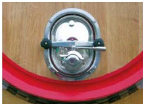
**Клапан из нержавеющей стали AISI 304 для полной разгрузки**
