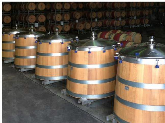
Коническая форма винификатора позволяет удерживать часть сформировавшейся шапки в погруженном состоянии, что способствует лучшей экстракции красящих и ароматических соединений. Также по запросу доступно оснащение для полного погружения шапки на период брожения. Опционально предоставляется оснащение для штабелирования двух винификаторов.
