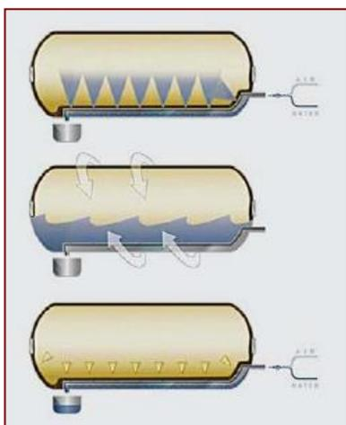
Важное отличие прессов Velvet от Diemme Enologia - это эксклюзивная **система автоматической мойки**. Данная система использует воду под давлением и сжатый воздух, что обеспечивает эффективную мойку емкости очистку дренажных каналов.
