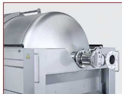
Циклические программы прессования позволяют настраивать схемы вращения емкости пресса и слива сока, обеспечивая отток сока во время заполнения пресса, что позволяет получить продукт максимального качества.
