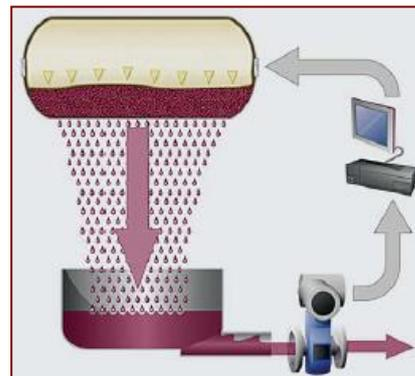
В прессах Velvet предусмотрена установка **рубашки охлаждения для контроля за температурой винограда** внутри пресса, кроме того термическая изоляция бункера емкости позволяет проводить технологические процессы под точным контролем температуры для производства ароматных высококачественных вин.
