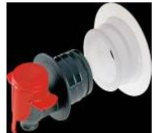
После наполнения адаптер вставляется полностью. Внешняя поверхность краника/уплотнения остается герметичной при различных температурных режимах. Специальная прокладка блокирует колпачок в закрытом положении, пока он не будет открыт конечным пользователем продукта.
