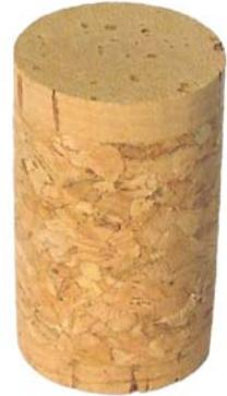
Для производства данного вида корковых пробок применяется абсолютно новая технология, принципиально отличающаяся от традиционного метода производства пробок «1+1». Агломерированная основа пробок **Double Disk** производится методом индивидуальной формовки или «moldation», при этом, на этой же стадии производства, к сформированной агломерированной основе с двух сторон одновременно приклеиваются натуральные диски.
